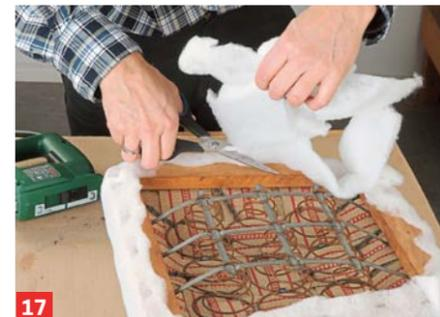
**17** Schneiden Sie die Vlies-Überstände ab. Das Vlies sollte später komplett vom Polsterstoff überdeckt werden.
