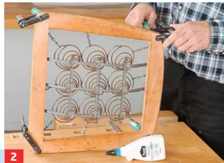
**2** Sollte der Rahmen an den Zapfenverbindungen aus dem Leim gegangen sein, können Sie diese nun neu verleimen.
