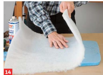
**14** Mit Sprühkleber fixieren Sie nun das Vlies auf dem Schaumstoff. Hier müssen rundum 6 bis 10 cm Vlies überstehen.
