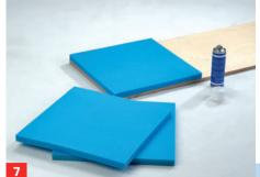
Kleben Sie mit Sprühkleber 50x50-cm-Schaumstoffplatten dicht nebeneinander auf die Polsterplatte und schneiden den ...
