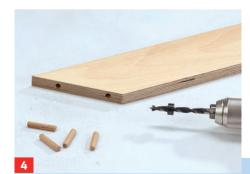
.... gerichtete Gehrungskante aufweist. Bohren Sie rechtwinklig zur Schnittfläche zwei Löcher in die Rahmen-Gehrungen
