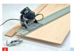
Handkreissäge schräg stellen (45°) und den ersten Multiplexstreifen entlang einer Führungsschiene abschneiden
