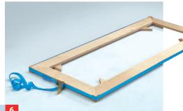
Sind alle Dübellöcher gebohrt, Leim angeben, Dübel einstecken und Rahmen mit Zurrgurt rechtwinklig verpressen
