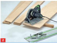
Anschließend die Säge wieder auf 90° aufrichten und drei weitere Streifen zuschneiden. Legen Sie nun Rahmen-Gehrungen ...
